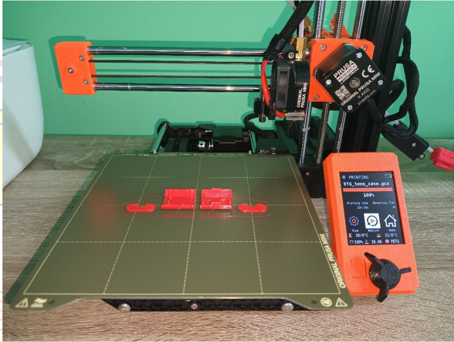
Slika 8 3D ispis kućišta senzora
