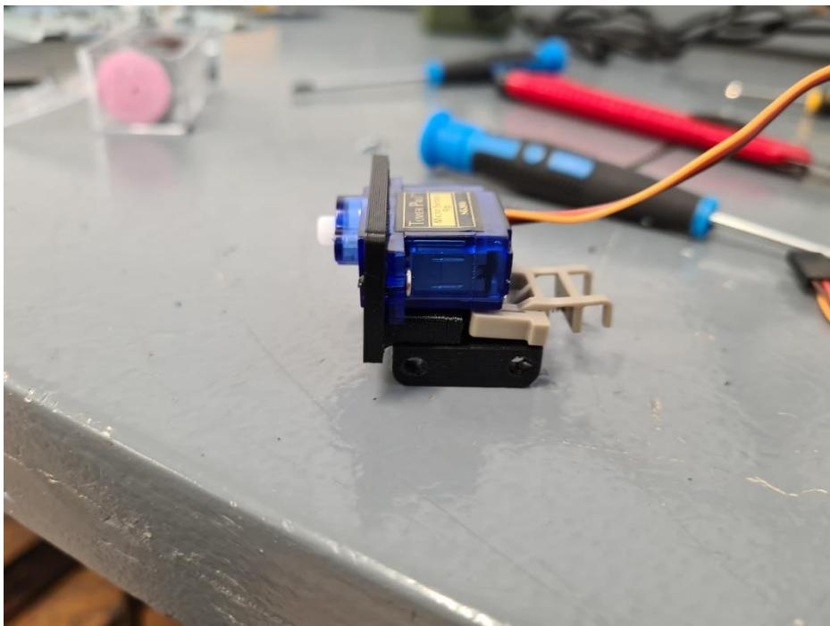
Slika 17: Montiranje servo motora na nosač
