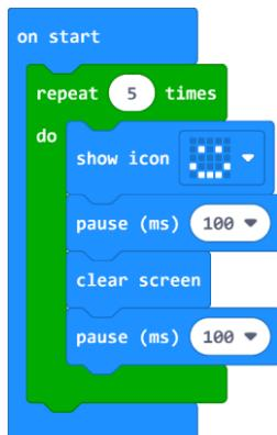
Prebacite program na micro:bit. Prilikom pokretanja, micro:bit će se nasmiješiti 5 puta, a nakon toga izbrisati ekran i vratiti na spavanje.
