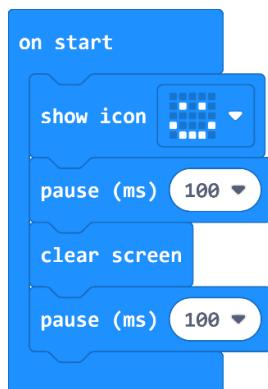
Pokrenite micro:bit simulator i primijetite kako se prilikom pokretanja micro:bita, smješko pojavio samo jednom.
