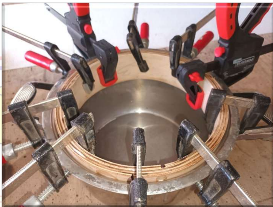
Slika 11 Izrada kružne nosive podloge za Vodotoranj
