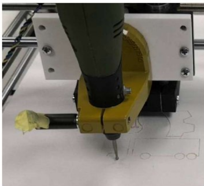
Slika 36: Montaža modificiranog nosača za ručno glodalo Proxxon
