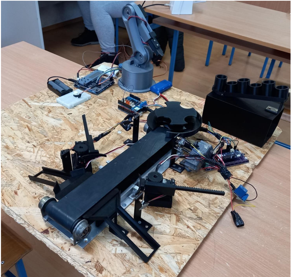
Slika 2. Gotova maketa automatizirane linije za punjenje bočica.
