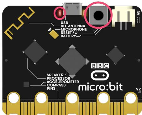
Sa stražnje strane micro:bita nalazi se tipkalo za ponovno pokretanje ili isključivanje micro:bita.
