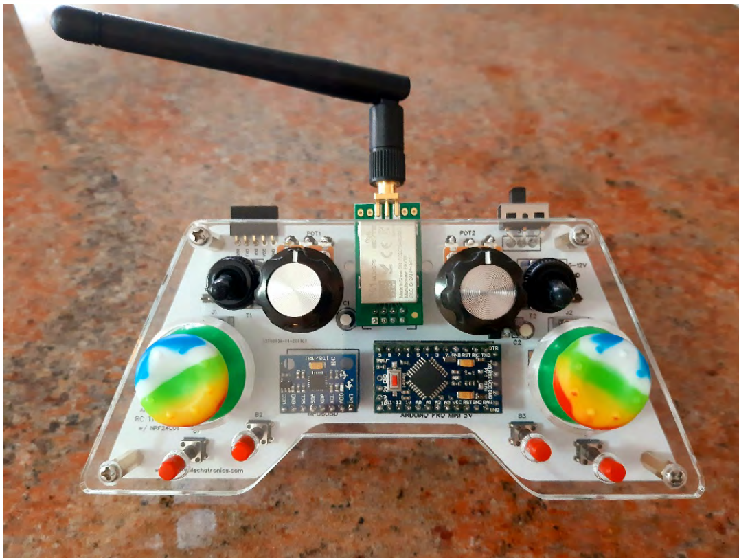
Slika 7 U potpunosti sastavljen Joystick za upravljanje putem NRF24L01 komunikacijskog modula
