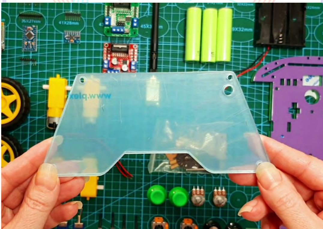
Slika 6 U potpunosti izrađena zadnja stana kućišta za Joystick
