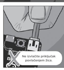
Ne izvlazite priključak povlačenjem žica.
